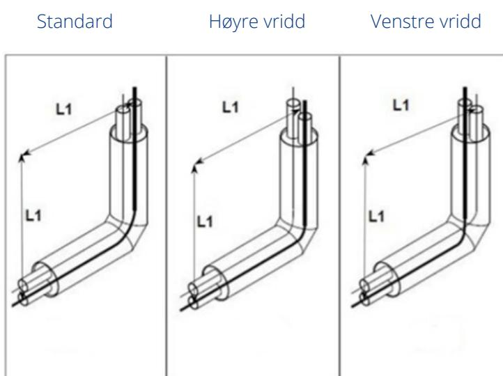
I tillegg finnes det vertikale 90° bend for fastmontasje og 90° bend med sprang for å ta opp en retningsforandring i profil. Standard gradtall i plan er 90° og avviking i profil er valgfritt. Ta kontakt.
