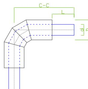
Formstøpte Isovarm PE bend og T-rør
