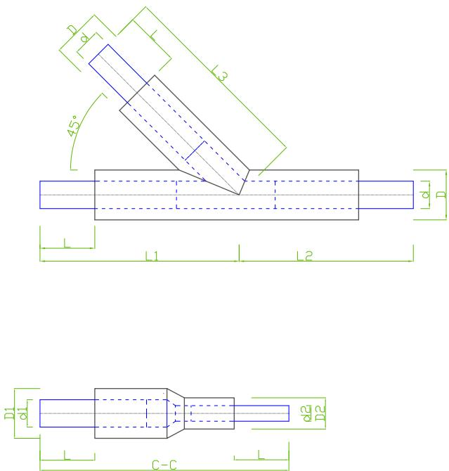
Isovarm PE reduksjon – standard byggemål for 1 nedtrapping: C-C=1000 mm, spissende som ovenfor nevnt.
